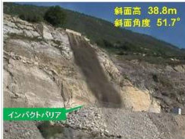
(1)実物大実験 土砂落下状況
